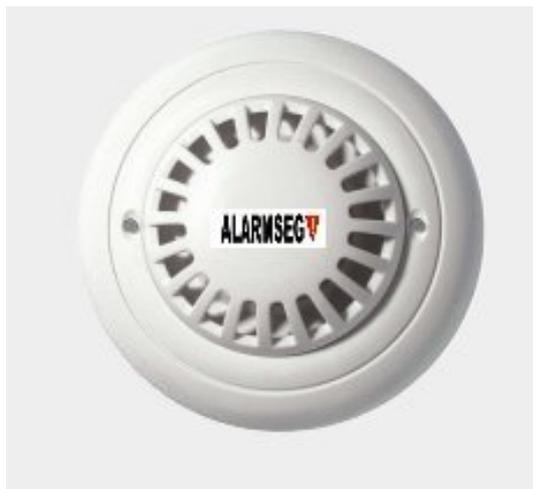
Este sensor possui uma câmara separada e calibrada a fim de evitar falsos disparos. A alimentação do sensor é regulada eletronicamente, mantendo desse modo uma sensibilidade constante do alarme. O ALM12 possui buzzer interno de 75dB e um led indicador de estado.
